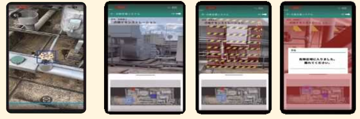
AI検知:対象物確認 点群データ活用:場所誘導・危険エリア検知
