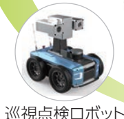
巡視点検ロボット
