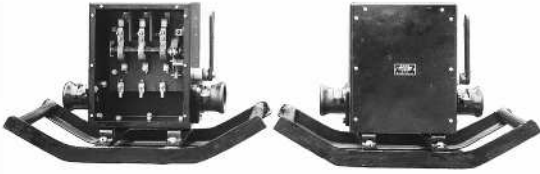
1955年頃 炭坑用防爆型配電函
