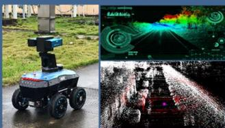
3Dレーザーセンサーでマップを作成し、自律走行します。点検内容、時間、サイクル等を設定すると、自動で巡視点検を行います。
