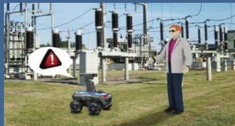
障害物がある場合は自動で停止します。また自己点検機能があり、異常時には警報灯を点滅させ、情報を監視システムへ転送します。
