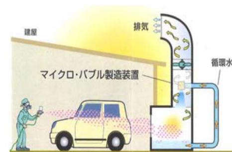
\* マイクロバブル製造装置とは有機溶剤を分解・消滅させ、サラサラな粉末状態に変化させます。
