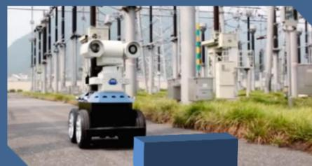
障害物がある場合は自動で停止します。また自己点検機能があり、異常時には警報灯を点滅させ、情報を監視システムへ転送します。
