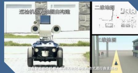
2Dレーザーセンサーでマップを作成し、自律走行します。点検内容、時間、サイクル等を設定すると、自動で巡視点検を行います。
