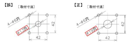
2) A-55 ページ「キーハンドル式 形式: JANK□、JARK□、JANR□K□、 YANK□、YARK□、YANR□K□」欄の [銘板部寸法]の下図の穴寸法および [取付寸法]を追記
