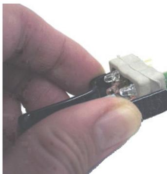
引き抜き工具により徐々に引き出し外す
