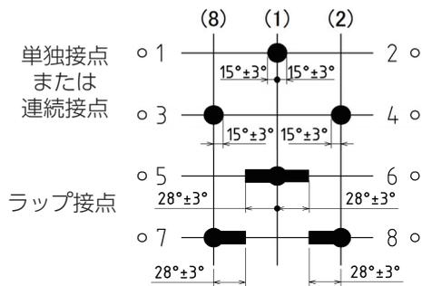
1-2の単独接点（または連続接点）の最大動作角度： $15^\circ + 3^\circ = 18^\circ$
