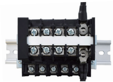
②圧着端子2枚重ね時の下側圧着端子の誤締付防止機構を採用。 (AT□-14の上側端子は8mm 2 以上)
